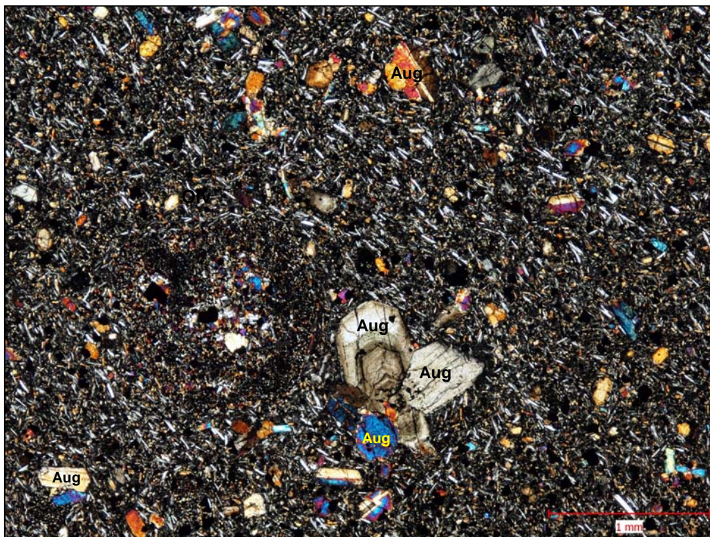
Foto 1. Velmi jemnozrný až jemnozrný bazalt až bazanit – porfyrický XPL, zvětšení 40x. Hlavní součástí základní hmoty horniny je agregát tvořený monoklinickým pyroxenem a plagioklasem. Na snímku jsou patrné drobné porfyrické vyrostlice augitu (Aug), které jsou místy koncentrovány do společných shluků.
