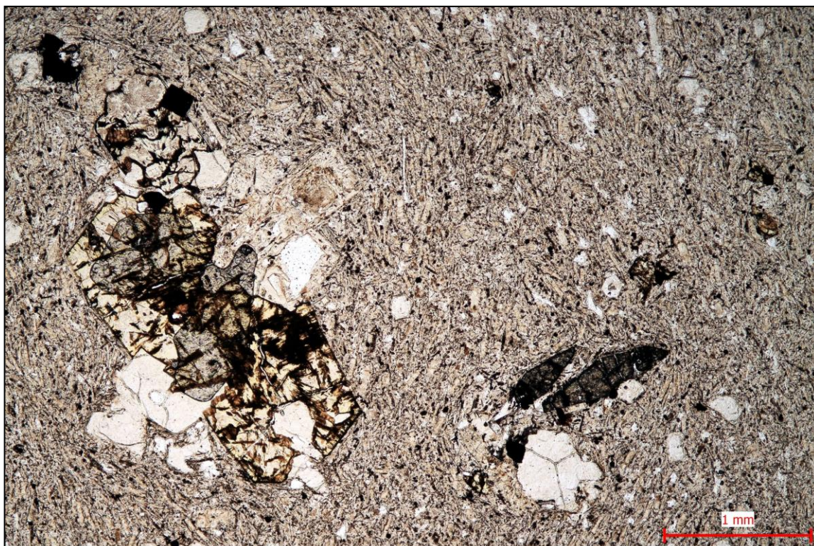
Foto 23. Alterovaný jemnozrný olivinický bazaltoid – porfyrický. PPL, zvětšení 40x. Porfyrické vyrostlice jsou v základní hmotě zastoupeny pseudomorfózami po monoklinických pyroxenech a olivínech, které si z větší části zachovaly svůj původní tvar primárních minerálů (hypidiomorfní až idiomorfní omezení). U četných porfyrických vyrostlic (pseudomorfóz – levá část snímku) podél zrn (tvorba výrazných lemů – kelyfitické obruby), nebo v četných puklinách (štěpné trhliny) vystupuje agregát, který je složen z rudního pigmentu a oxidů–hydroxidů Fe–Mn.
