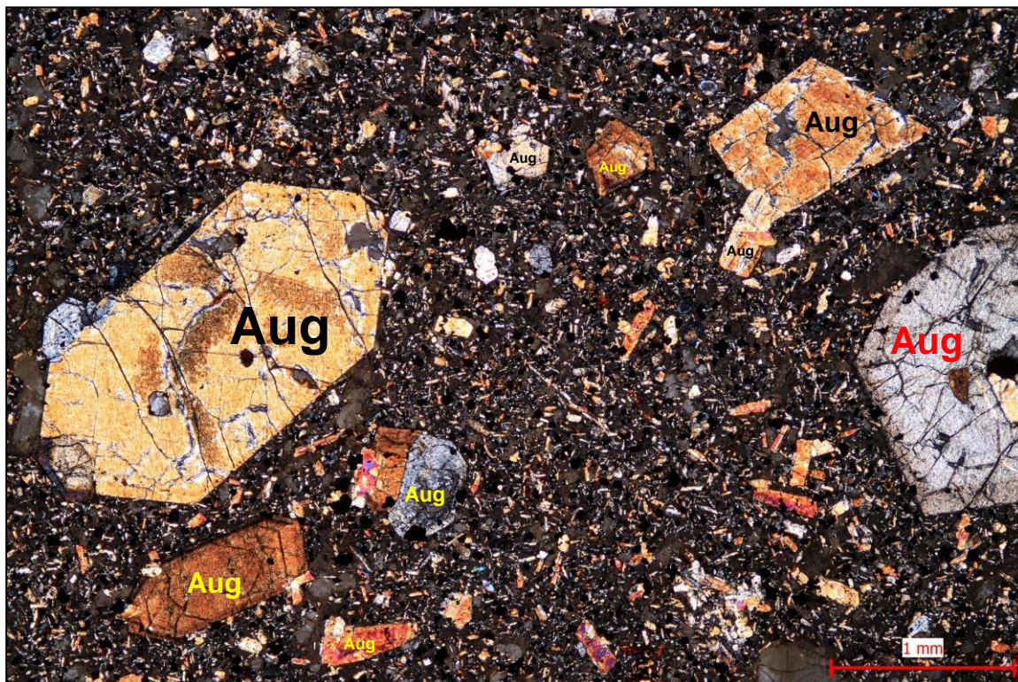
Foto 33. Porfyrický, velmi jemnozrnný až jemnozrnný olivinický bazalt až bazanit – vzorek 60/16/22. XPL, zvětšení 40x. Hlavní součástí základní hmoty horniny je velmi jemnozrnný až jemnozrnný agregát tvořený monoklinickými pyroxeny, plagioklasy a foidy. U tohoto vzorku jsou porfyrické vyrostlice zastoupeny především monoklinickými pyroxeny – augity (Aug).
