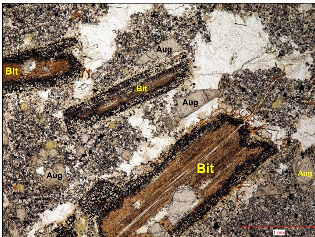
Foto 5. Jemnozrnňý olivinický bazalt až bazanit – porfyrický PPL, zvětšení 40x. Hlavní součástí základní hmoty horniny je agregát tvořený monoklinickým pyroxenem, plagioklasem a foidy (leucitem ?). V této základní hmotě horniny jsou patrné více či méně přednostně uspořádané šupinky (lupínky) biotitu (Bit). Kolem šupinek biotitu je vyvinut lem, který je složen z drobných zrníček oxidu–hydroxidu Fe a méně zastoupeného opakního rudního minerálu. Augit (Aug).
