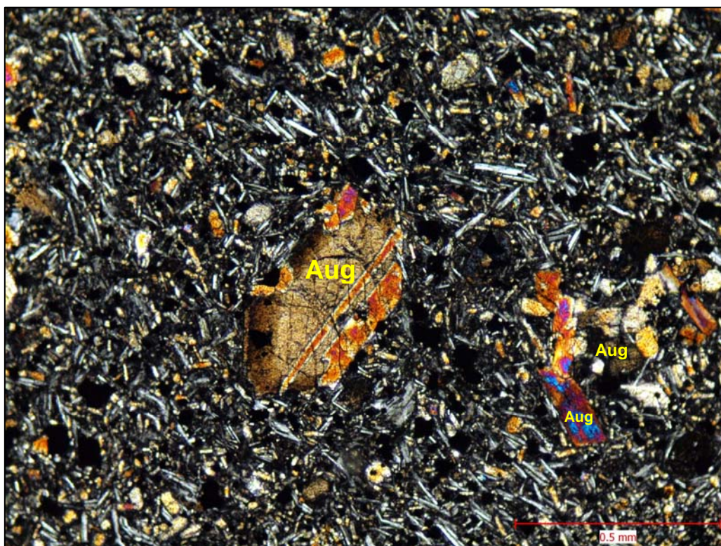
Foto 2. Velmi jemnozrný až jemnozrný bazalt až bazanit – porfyrický XPL, zvětšení 100x. Hlavní součástí základní hmoty horniny je agregát tvořený monoklinickým pyroxenem a plagioklasem. Uprostřed snímku je patrná drobná porfyrická vyrostlice monoklinického pyroxenu (augitu) s patrným dvojčatným srůstem (lamelování).
