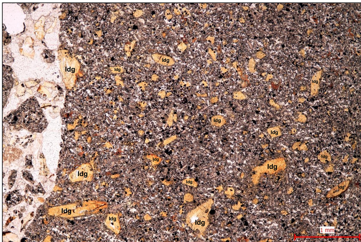
Foto 11. Vulkanická brekcie. PPL, zvětšení 40x. Hlavní součástí základní hmoty bazaltů až bazanitů (práva část snímku) je agregát tvořený monoklinickým pyroxenem, plagioklasem a foidy. Na snímku jsou v základní hmotě horniny zastoupeny tzv. pseudomorfózy po olivínech (iddingsit – ldg), kde v produktu přeměn vystupuje především jílový minerál, chlorit, rudní pigment oxidu–hydroxidu Fe–Mn a minerály serpentínové skupiny. Některé pseudomorfózy si zachovaly původní tvar primárního olivínu (hypidiomorfní omezení).
