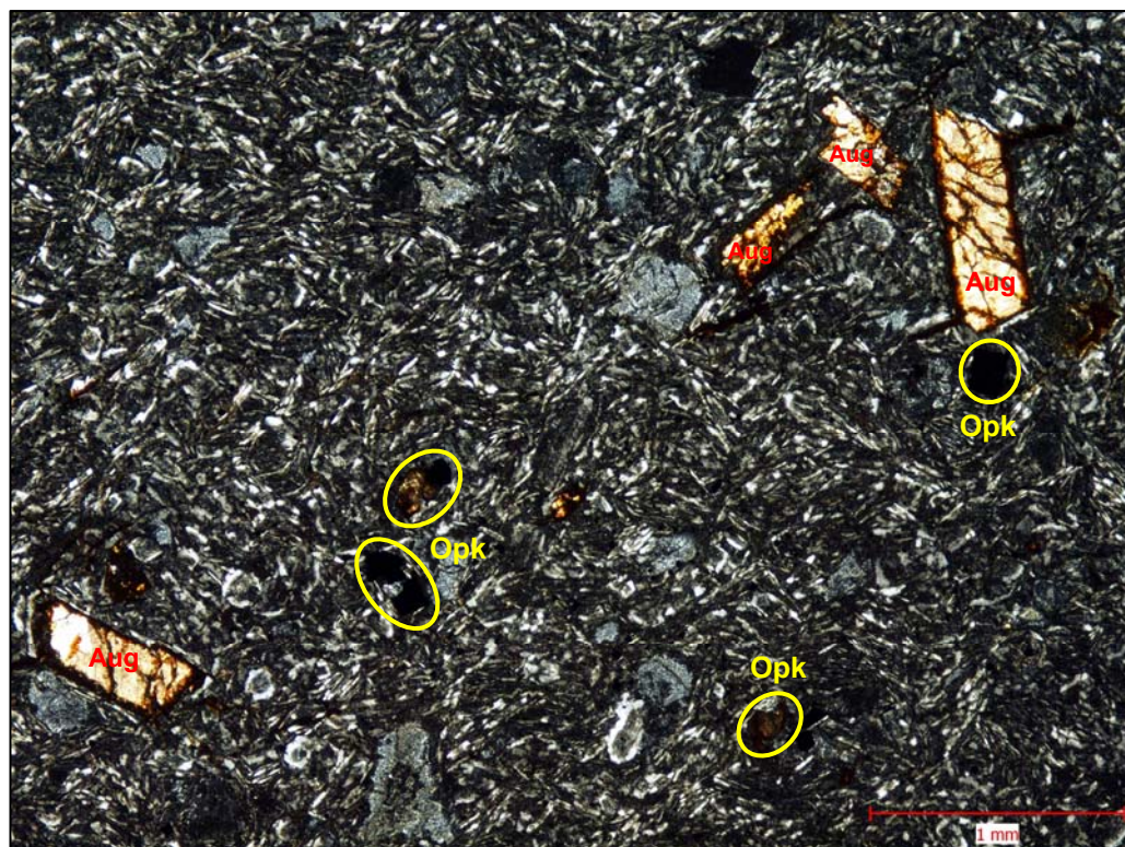
Foto 8. Velmi jemnozrný olivínický bazaltoid, porfyrický – vzorek 72/13/22. XPL, zvětšení 40x. Hlavní součástí základní hmoty horniny je velmi jemnozrný až jemnozrný agregát tvořený živci (většinou více či méně alterované plagioklasy) a monoklinickým pyroxenem. Porfyrické vyrostlice jsou zastoupeny prakticky výhradně pseudomorfózami po monoklinickém pyroxenu (Aug). V odebraných vzorcích jsou přítomny oválné nebo různě nepravidelně protažené mandle, které jsou vyplněné fýlosilikátovým mikro – kryptoagregátem.
