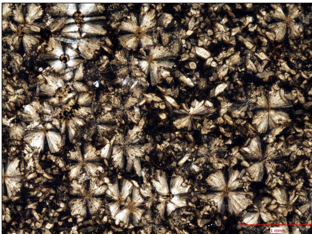
Foto 2. Karbonát – vzorek 85/12/22. XPL, zvětšení 40x. Na snímku je dobře patrná sférolitická struktura, která je tvořena kulovitými tělisky s radiálně paprscitou stavbou. Sférolity jsou na snímku tvořeny sideritem, který je místy více či méně zakalen (pigmentován) oxidy–hydroxidy Fe a Mn.
