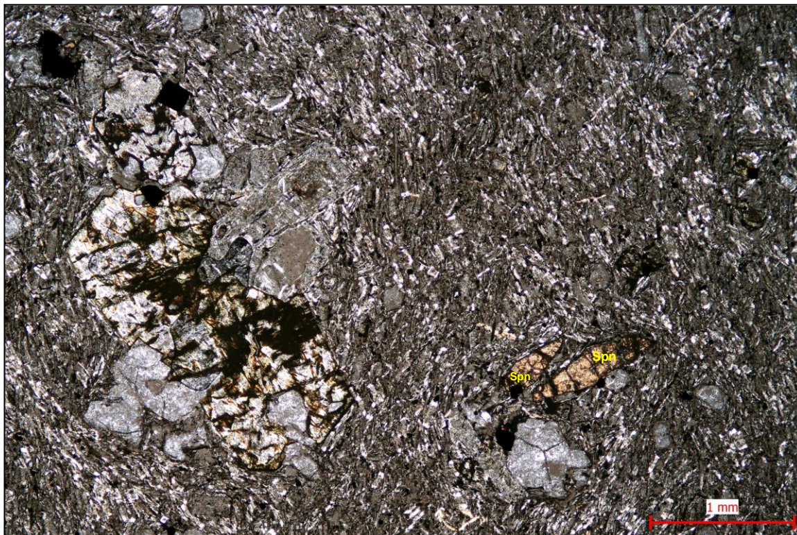
Foto 22. Alterovaný jemnozrný olivinický bazaltoid – porfyrický. XPL, zvětšení 40x. Porfyrické vyrostlice jsou v základní hmotě zastoupeny pseudomorfózami po monoklinických pyroxenech a olivínech, které si z větší části zachovaly svůj původní tvar primárních minerálů (hypidiomorfní až idiomorfní omezení). V základní hmotě horniny vystupují ve formě izolovaných porfyrických vyrostlic, nebo jsou místy koncentrovány do menších či větších shluků, společně s opakním rudním minerálem a sporadicky zastoupeným titanitem (Spn).
