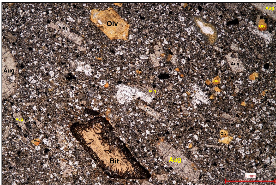
Foto 6. Porfyrický olivinický foidit. PPL, zvětšení 40x. Porfyrické vyrostlice jsou zastoupeny především augity (Aug), pseudomorfozami po olivínech (Olv) a v menší míře většími šupinkami biotitů. V menší míře zastoupený biotit (Bit) vystupuje většinou ve formě izolovaných, prakticky zdravých šupin vel. do 2 mm. Kolem četných šupin (spodní část snímku) jsou vyvinuty drobné lemy, které jsou složeny z krátce sloupečkovitých (vláknitých) krystalků tvořené opakními minerály a sklem, pigmentovanými oxidy–hydroxidy Fe–Mn.
