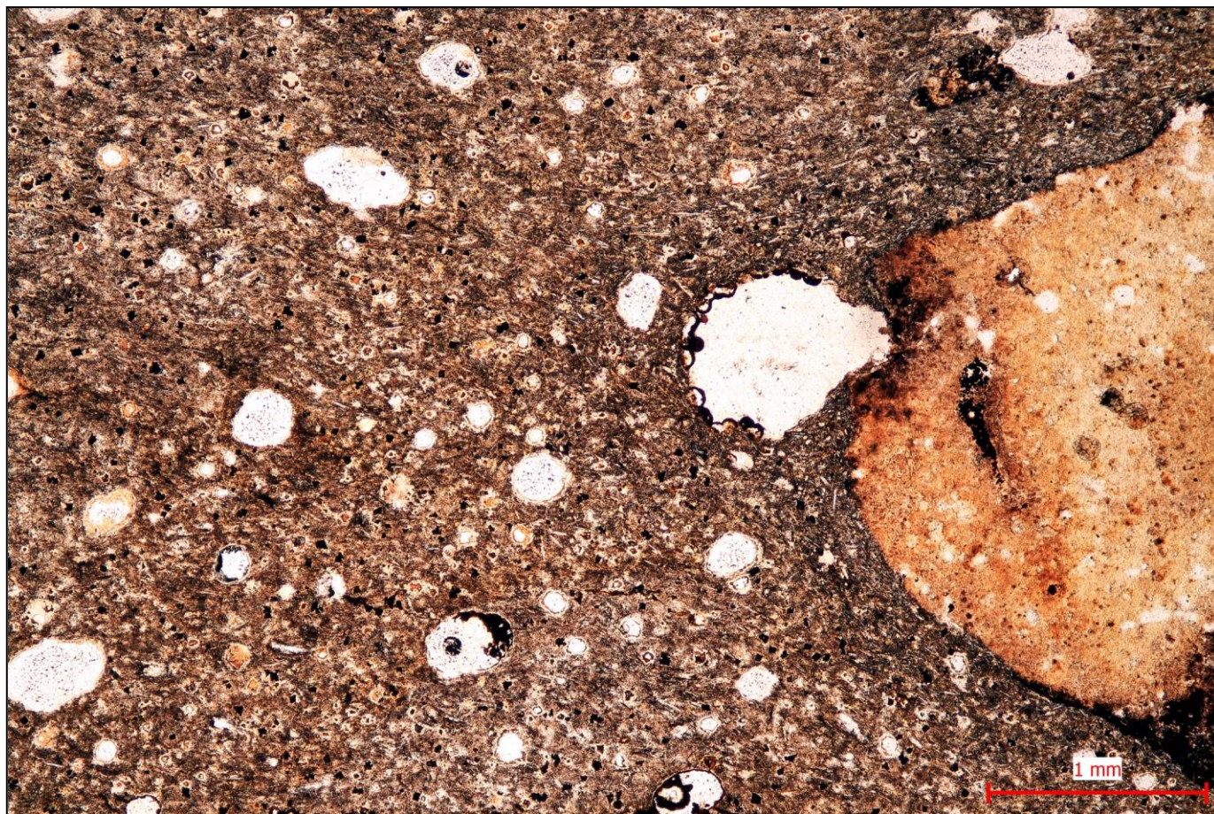
Foto 2. Výrazně alterovaný sklovitý bazaltoid s xenolity jílovců (slínovců?). PPL, zvětšení 40x. Odebraný vzorek horniny je zastoupen alterovaným sklovitým bazaltoidem, kde došlo k totální alteraci primární sklovité hmoty na fylosilikátový mikro–kryptoagregát (jílový minerál, chlorit), který je výrazně prosycen oxidy–hydroxidy Fe–Mn, společně s rudním opakním pigmentem. V této základní hmotě horniny jsou patrné četné, oválné, místy nevýrazně laločnaté, izometrické nebo různě nepravidelně protažené mandle, které jsou většinou bez výplně. V této základní hmotě horniny (alterovaný sklovitý bazaltoid) jsou uloženy relativně četné xenolity (horninové klasy) sedimentárních hornin (pravá část snímku), které jsou prakticky výhradně zastoupeny písčitými až prachovitými jílovcí (slínovci?).
