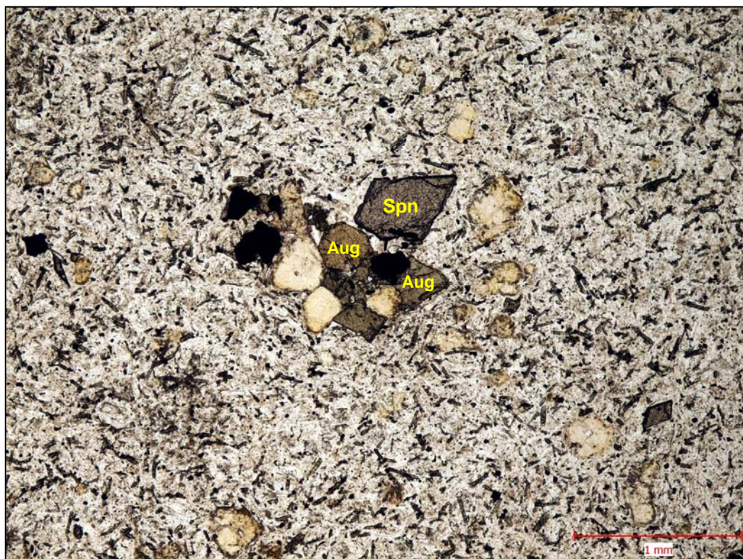
Foto 12. Andezit. PPL, zvětšení 40x. Hlavní součástí základní hmoty horniny je agregát, tvořený monoklinickými pyroxeny (augity) a plagioklasy. Základní hmota horniny je místy více či méně zakalená (pigmentovaná) oxidy–hydroxidy Fe, nebo prostoupená karbonátovým mikroagregátem. Augit (Aug), titanit (Spn).
