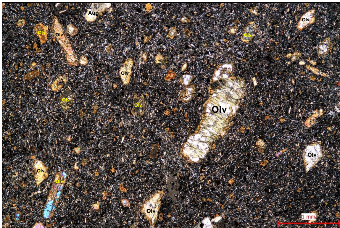
Foto 27. Olivinický bazalt až bazanit – vzorek 58/16/22. XPL, zvětšení 40x. Porfyrické vyrostlice jsou zastoupeny především více či méně alterovanými olivíny (Olv), nebo jejich tzv. pseudomorfózami po olivínech a v menší míře monoklinickými pyroxeny (Aug). Porfyrické vyrostlice olivínů jsou v základní hmotě horniny zastoupeny prakticky zdravými, většinou více či méně alterovanými zrn (alterace olivínu je nejintenzivnější podél zrn – tvorba lemů a v intergranulárních spárách – rozpukání zrn), nebo jejich tzv. pseudomorfózami.
