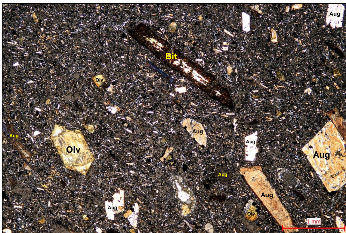
Foto 5. Porfyrický olivinický foidit. XPL, zvětšení 40x. Hlavní součástí základní hmoty horniny je velmi jemnozrný až jemnozrný agregát tvořený monoklinickým pyroxenem (augitem) a foidy. Porfyrické vyrostlice jsou zastoupeny především monoklinickými pyroxeny – augity (Aug), olivíny (pseudomorfozy po olivínech – Olv) a v menší míře většími šupinkami biotitů (Bit). Pseudomorfozy po olivínech si zachovaly z větší části svůj původní tvar primárních olivínů – levá část snímku (hypidiomorfní až idiomorfní omezení).
