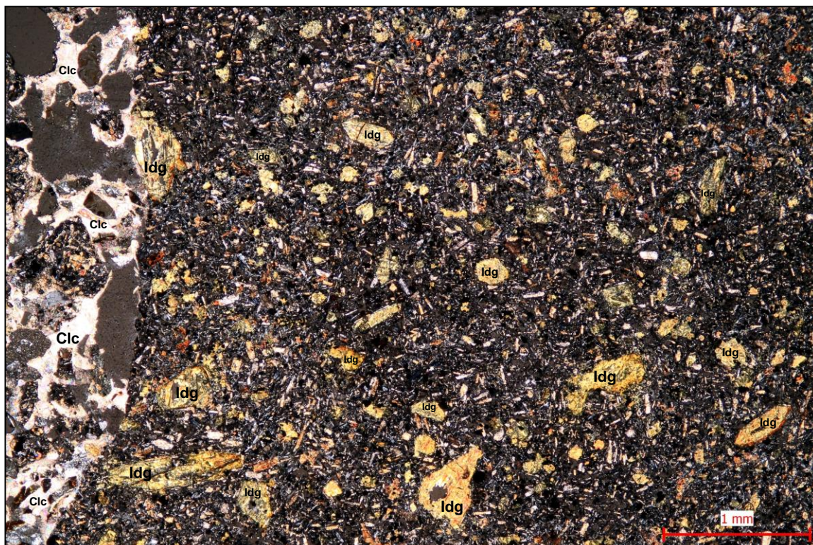
Foto 12. Vulkanická brekcie. XPL, zvětšení 40x. Hlavní součástí základní hmoty bazaltů až bazanitů (práva část snímku) je agregát tvořený monoklinickým pyroxenem, plagioklasem a foidy. Na snímku jsou v základní hmotě horniny zastoupeny tzv. pseudomorfózy po olivínech (iddingsit – ldg), kde v produktu přeměn vystupuje především jílový minerál, chlorit, rudní pigment oxidu–hydroxidu Fe–Mn a minerály serpentínové skupiny. Některé pseudomorfózy si zachovaly původní tvar primárního olivínu (hypidiomorfní omezení). Karbonát (Clc).
